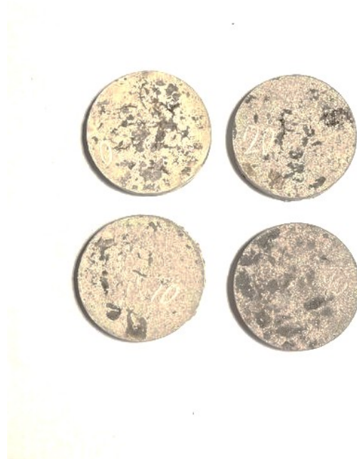
Рисунок 3 - Образцы из галлуазита с различным содержанием металлических отходов DOI: https://doi.org/10.60797/IRJ.2025.160s.33.3
