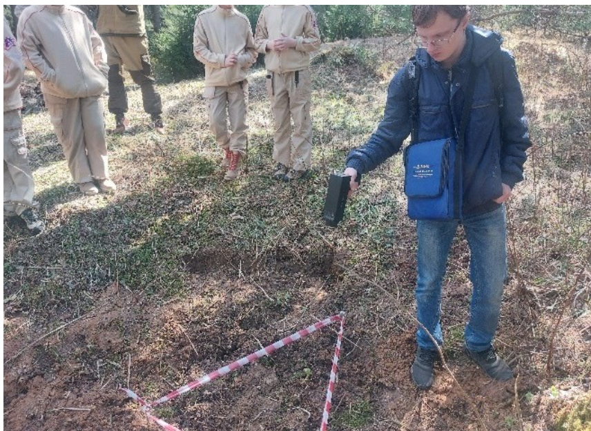
Рисунок 2 - Использование контрастометра «Искатель» в полевом эксперименте
