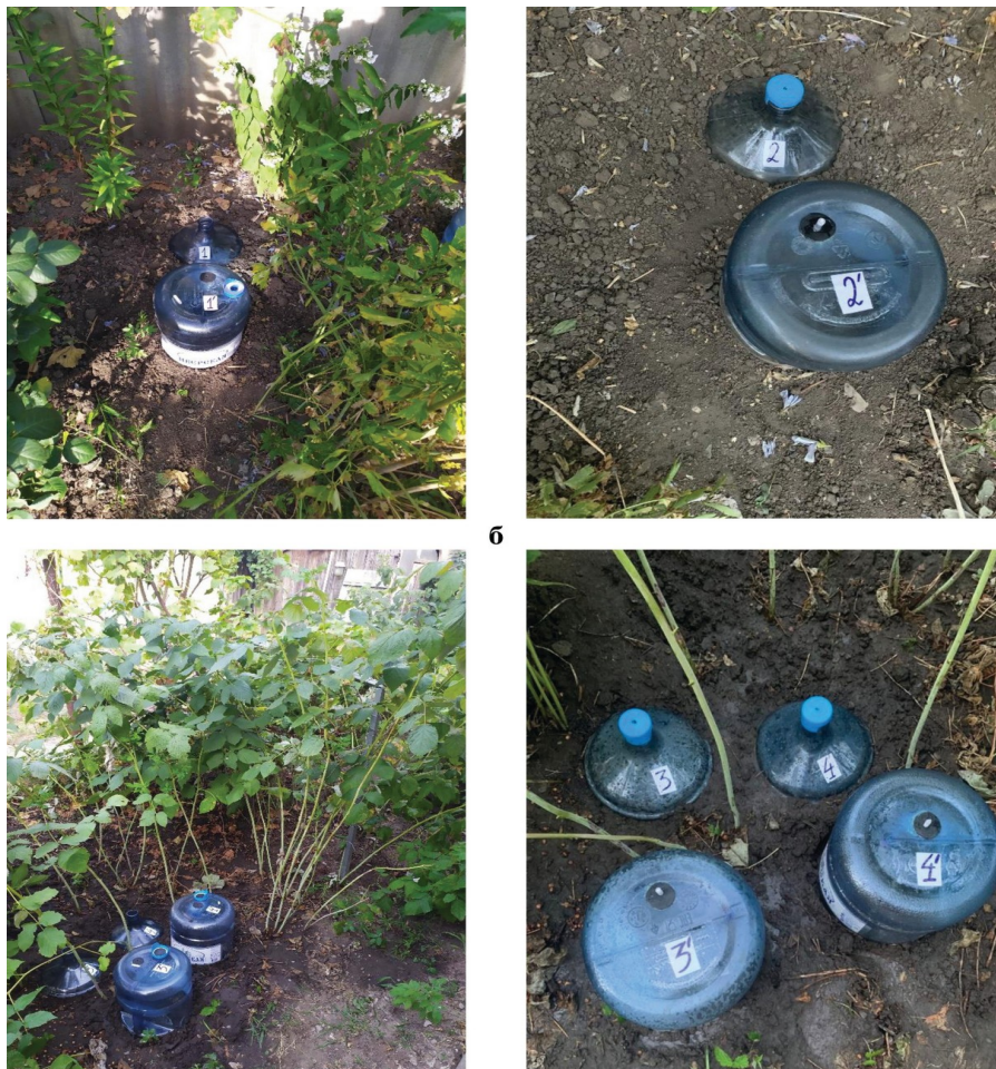
Рисунок 1 - Фото ловушек (№№ 1 и 2 – первый полигон), установленных на черноземах естественной влажности (а), и ловушек (№№ 3 и 4 – второй полигон), установленных на черноземах, искусственно увлажняемых в ходе эксперимента (б)
