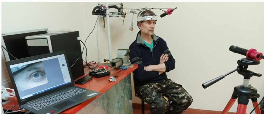
Рисунок 1 - Модернизированный экспериментальный модуль «Айтрекинг» DOI: https://doi.org/10.60797/IRJ.2025.161.79.1
