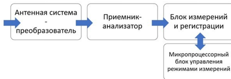
Рисунок 1 - Функциональная блок-схема ПАК DOI: https://doi.org/10.60797/IRJ.2025.160.10.1
