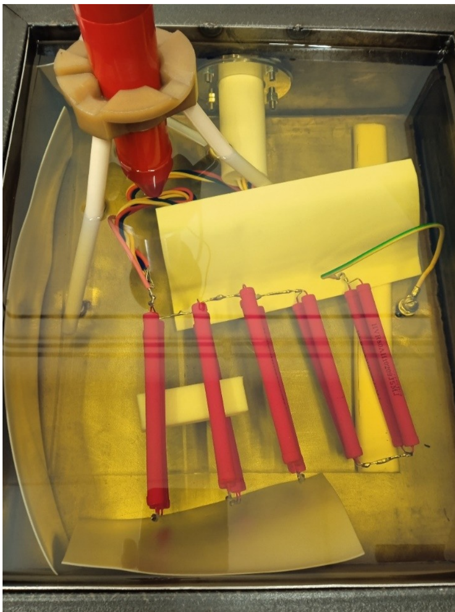
Рисунок 6 - Высоковольтные резисторы в качестве нагрузки в реальном источнике DOI: https://doi.org/10.60797/IRJ.2025.160s.8.6
