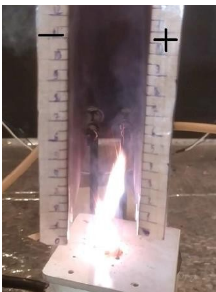
Рисунок 3 - Отклонение потока частиц реагента при возгонке в электрическом поле DOI: https://doi.org/10.60797/IRJ.2025.160.84.5
