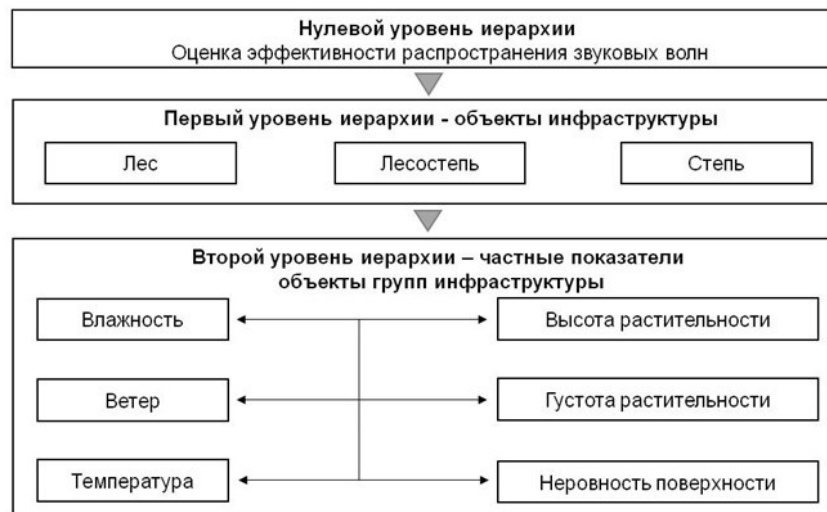
Рисунок 1 - Иерархическая модель оценки распространения звука в различных природно-климатических условиях DOI: https://doi.org/10.60797/IRJ.2025.158.17.1
