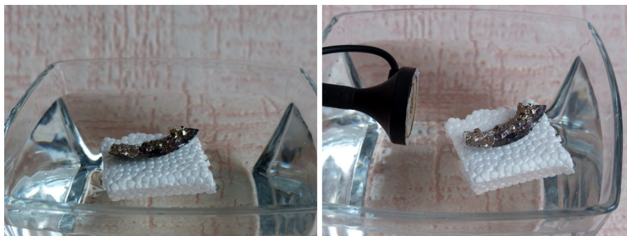
Рисунок 5 - Исследование диамагнитных свойств висмута (2) DOI: https://doi.org/10.23670/IRJ.2022.125.19.5
