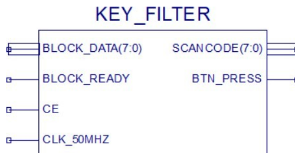
Рисунок 5 - Блок KEY_FILTER DOI: https://doi.org/10.60797/IRJ.2025.158.44.5
