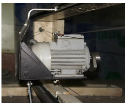
Рисунок 7 - Каркас-двигателя, оборудованный растяжками DOI: https://doi.org/10.60797/IRJ.2025.160.26.7
