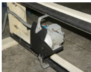
Рисунок 4 - Двигатель имитирующей воздействие массы грузовой двери DOI: https://doi.org/10.60797/IRJ.2025.160.26.4
