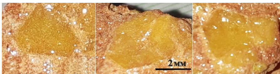
Рисунок 2 - Внешний вид выращенных монокристаллов \text{Pb}_{1.42(8)}[\text{Nb}_{0.79(2)}\text{Al}_{0.20(2)}\text{Mg}_{0.011(5)}]\text{O}_{6.5} . DOI: https://doi.org/10.60797/IRJ.2025.156.66.3
