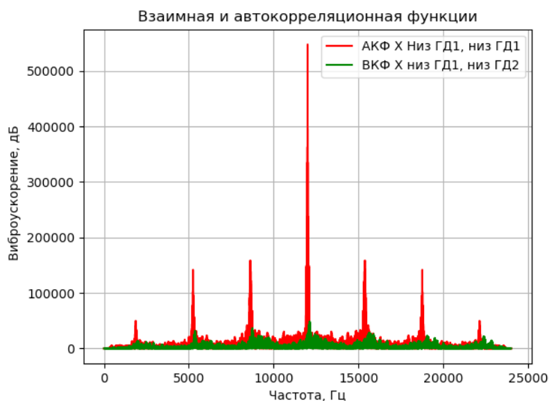
Рисунок 3 - Автокорреляционная и взаимокорреляционная функции виброакустических сигналов, сдвинутых на величину разности по времени между максимумами АКФ и ВКФ ГД № 1 и ГД № 2 DOI: https://doi.org/10.60797/IRJ.2025.155.31.3
