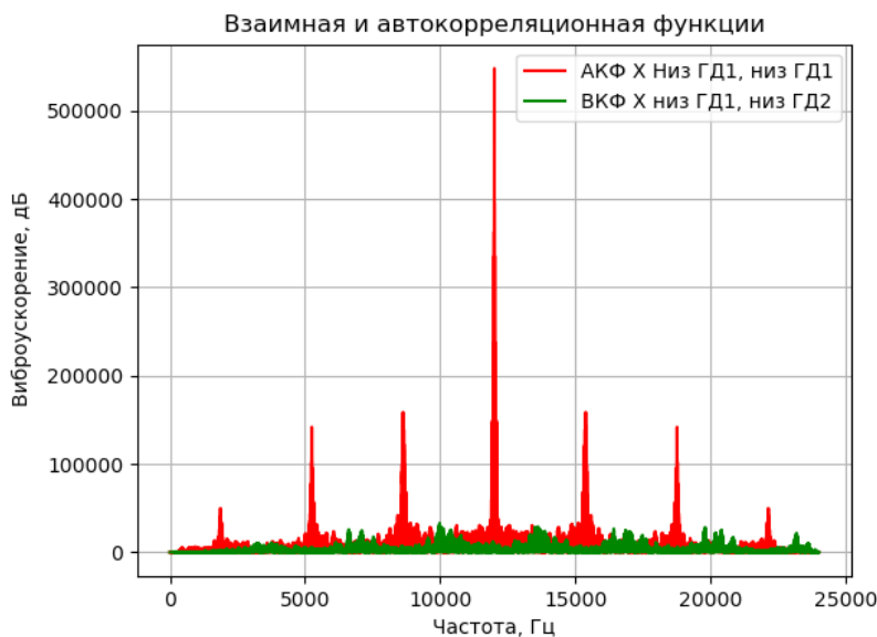
Рисунок 2 - Автокорреляционная и взаимокорреляционная функции сигналов ГД № 1 и ГД № 2 DOI: https://doi.org/10.60797/IRJ.2025.155.31.2
