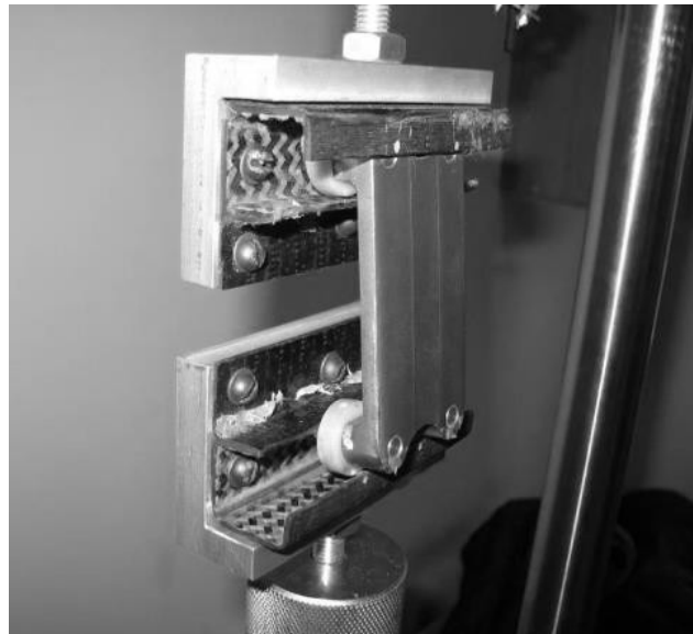
Рисунок 7 - Положение каретки с роликами после разрушения нижнего рельса DOI: https://doi.org/10.60797/IRJ.2025.153.97.7
