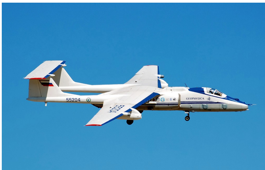
Рисунок 4 - Внешний вид авиационной геофизической лаборатории «Геофизика» на базе высотного самолета-разведчика М-55 DOI: https://doi.org/10.60797/IRJ.2025.153.32.4
