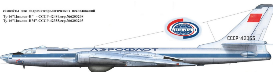
Рисунок 2 - Внешний вид АМЛ на базе бомбардировщика-ракетоносца Ту-16, созданного для экспериментов по программе «Циклон» DOI: https://doi.org/10.60797/IRJ.2025.153.32.2
