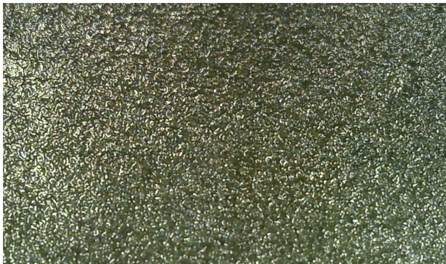
Рисунок 5 - Поверхность капли электропроводящей магнитной жидкости, не подвергнутой воздействию магнитного поля, при 40 – кратном увеличении DOI: https://doi.org/10.60797/IRJ.2025.154.23.6
