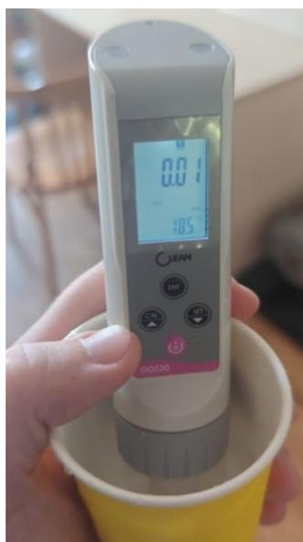
Рисунок 6 - Фотография процесса измерения растворенного озона в полученном растворе при  $Q = 0,1$  л/мин
