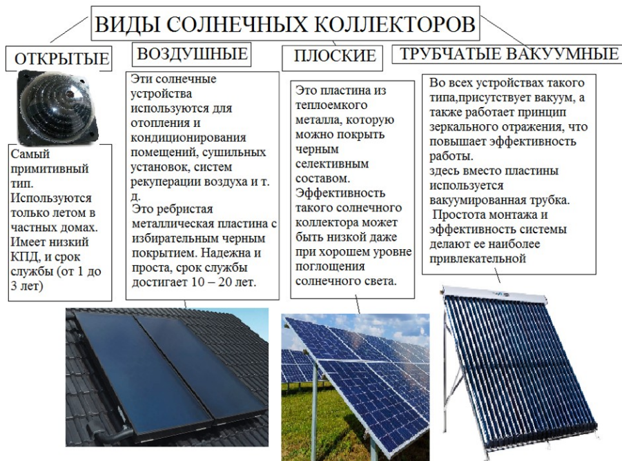
Рисунок 5 - Виды современных гелиоколлекторов DOI: https://doi.org/10.60797/IRJ.2025.152.64.6
