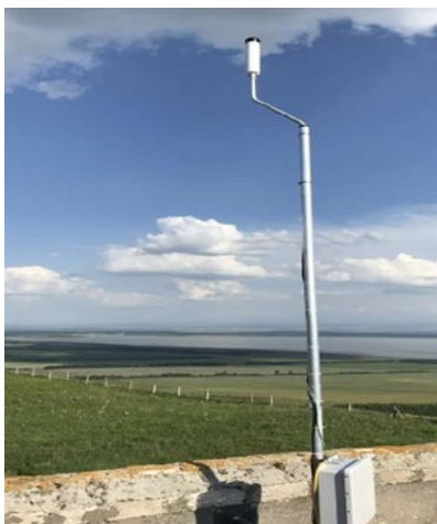
Рисунок 1 - Датчик грозорегистратора Total Lightning Network фирмы Earth Networks, установленный в пункте Черкесск
