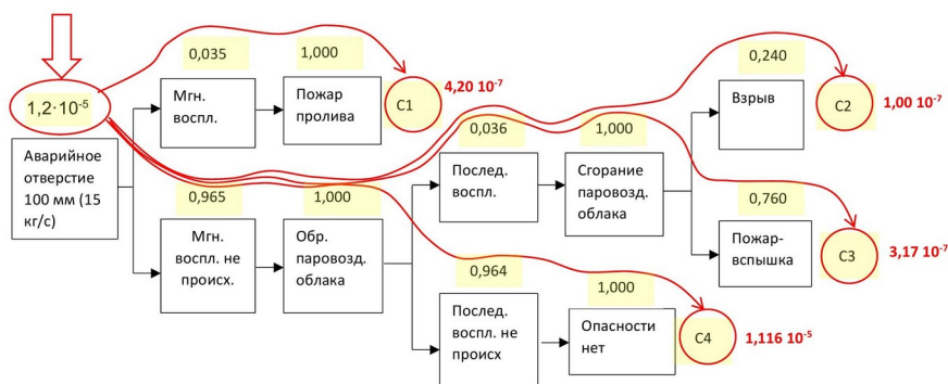
Рисунок 6 - Последовательность расчёта частоты реализации сценария с помощью логического дерева событий
