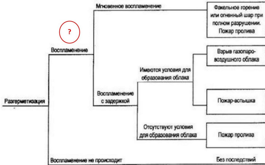
Рис. П3.2. Типовое дерево событий при возникновении и развитии пожароопасной ситуации, связанной с разгерметизацией единицы технологического оборудования (1-го аппарата) и истечением жидкой фазы или двухфазной смеси СУГ или ЛВЖ
