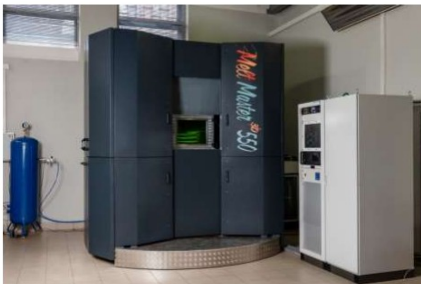
Рисунок 7 - Экспериментальная плазменная установка MeltMaster3D-550, разработанная на базе АО «НПО «ЦНИИТМАШ» [8]
