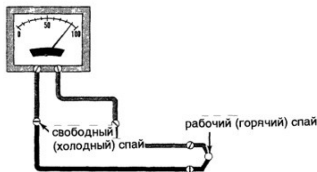
Рисунок 1 - Устройство термопары
