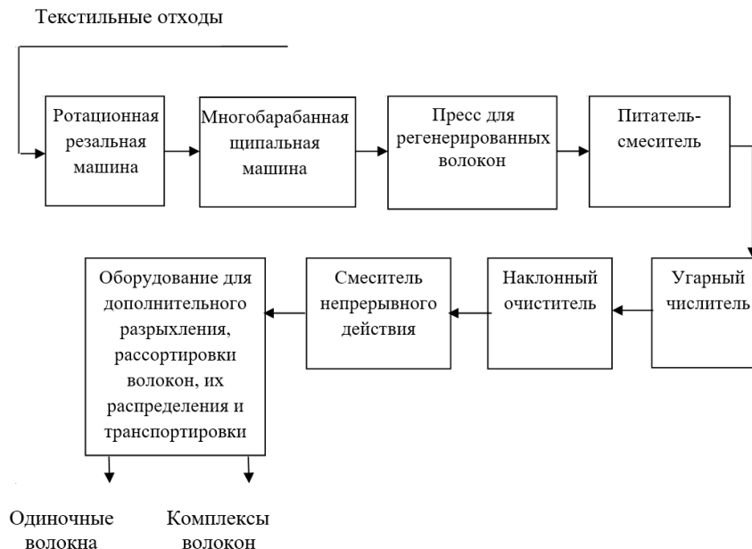
Рисунок 3 - Схема разработанной технологической линии переработки текстильных отходов и получения регенерированных волокон
