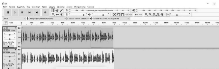
Рисунок 8 - Цифровая шумоочистка аудио сигнала, модулированного РП диктора DOI: https://doi.org/10.60797/IRJ.2024.147.60.16
