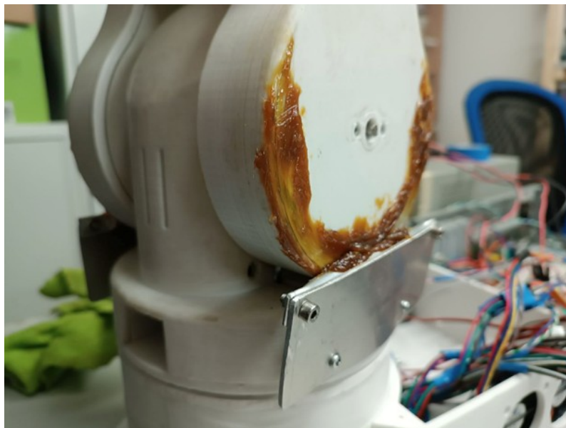
Рисунок 5 - Усиление конструкции робота алюминиевыми вставками DOI: https://doi.org/10.60797/IRJ.2024.146.143.5
