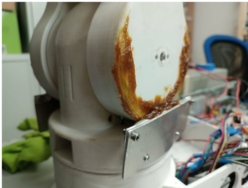
Рисунок 5 - Усиление конструкции робота алюминиевыми вставками
