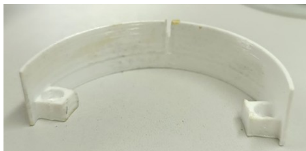
Рисунок 7 - Ответная часть концевого переключателя DOI: https://doi.org/10.60797/IRJ.2024.146.143.7
