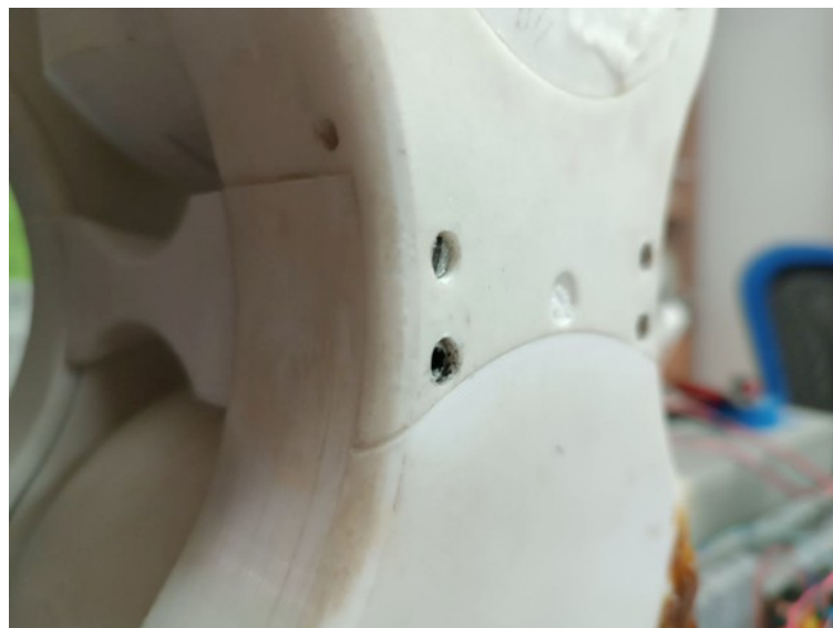
Рисунок 4 - Результат склеивания разделенной детали DOI: https://doi.org/10.60797/IRJ.2024.146.143.4
