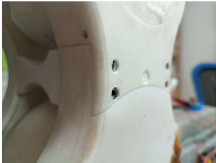
Рисунок 4 - Результат склеивания разделенной детали
