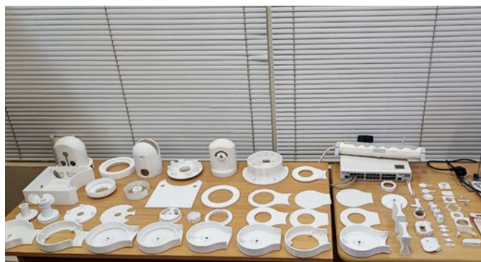
Рисунок 2 - Комплект распечатанных на 3D-принтере деталей робота DOI: https://doi.org/10.60797/IRJ.2024.146.143.2
