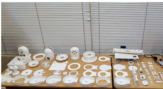
Рисунок 2 - Комплект распечатанных на 3D-принтере деталей робота
