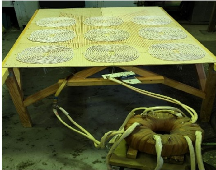
Рисунок 11 - Макет плоского индуктора, состоящего из 9 индукторов 340мм x 300мм, 16 витков из двойного провода ЛЭЛО 1075x0,071
