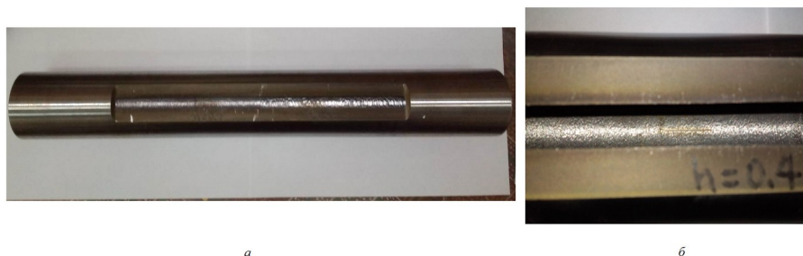
Рисунок 1 - Внешний вид образцов труб НКТ и дефектов для исследований:
