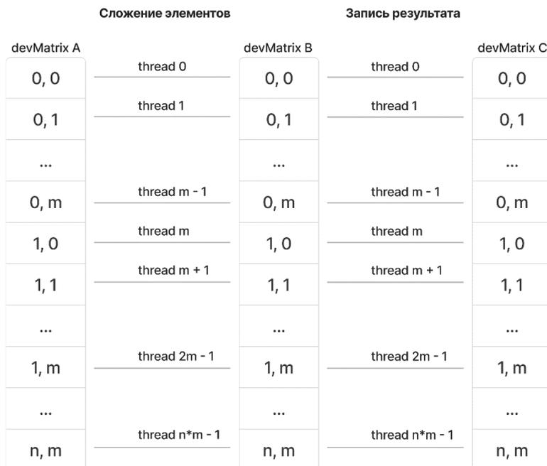
Рисунок 1 - Блок-схема суммы матриц
