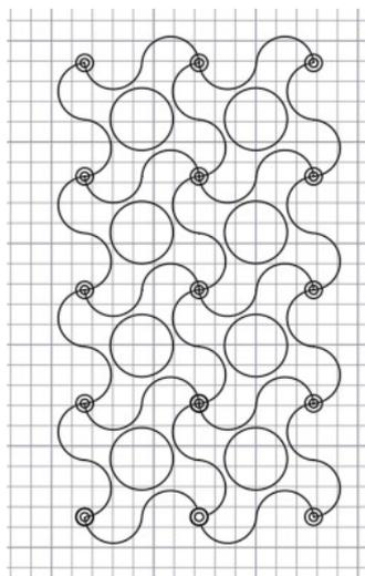
Рисунок 1 - Общий вид решетки рассматриваемого моностабильного ауксетика
