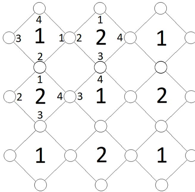
Рисунок 2 - Общий вид схемы строения шарниров рассматриваемого моностабильного ауксетика
