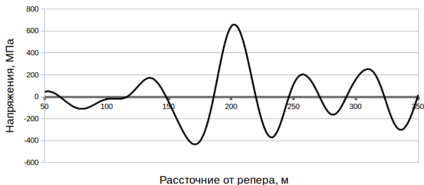
Рисунок 3 - Напряжения в подземном трубопроводе DOI: https://doi.org/10.60797/IRJ.2024.145.92.3
