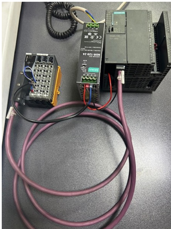
Рисунок 8 - Коммутация котроллера, блока питания и модуля расширения DOI: https://doi.org/10.60797/IRJ.2024.145.83.8
