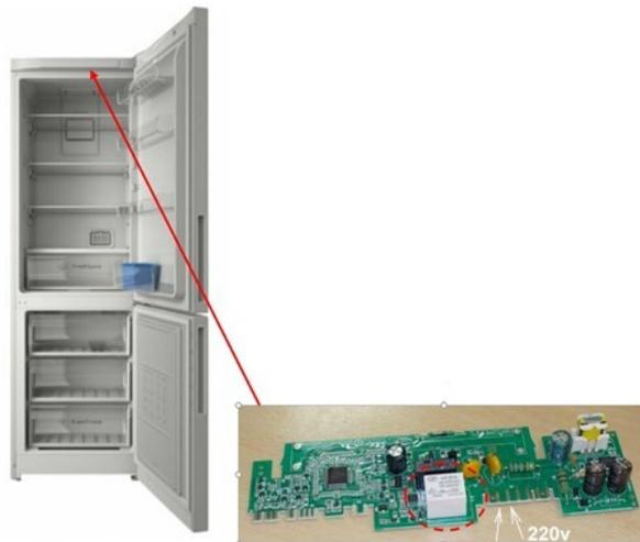
Рисунок 2 - Холодильник Indesit и управляющая плата, расположенная под верхней крышкой холодильника в лицевой части
