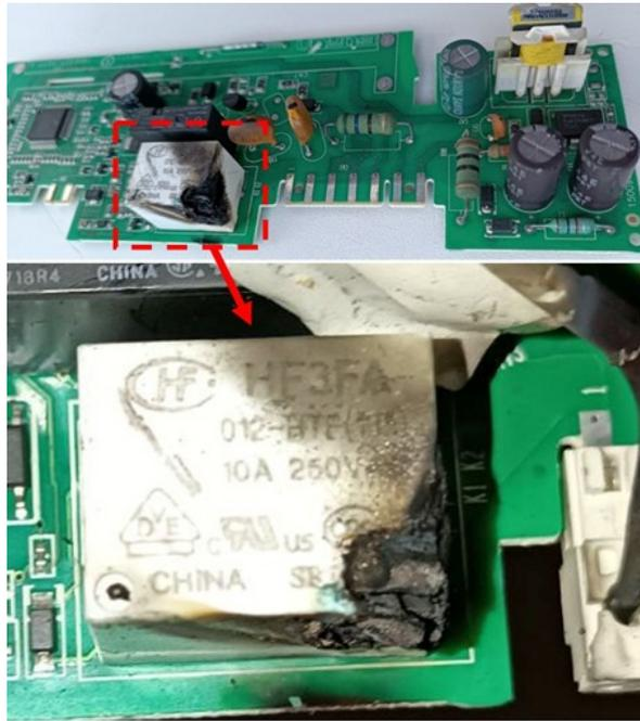
Рисунок 3 - Последствия работы реле в течение 30 месяцев
