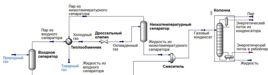
Рисунок 2 - Схема низкотемпературной сепарации природного газа с применением дросселя
