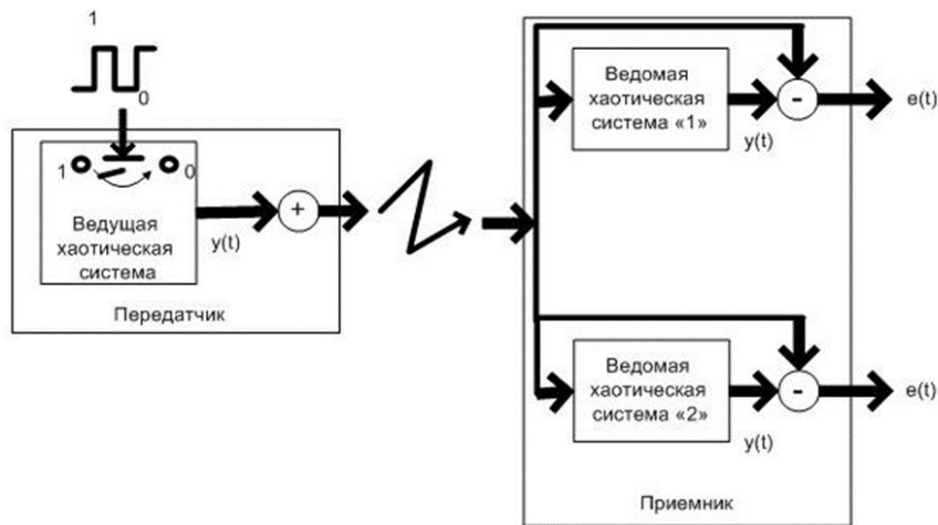
Рисунок 7 - Схема использования переключения хаотических режимов для передачи информации DOI: https://doi.org/10.60797/IRJ.2024.145.167.7
