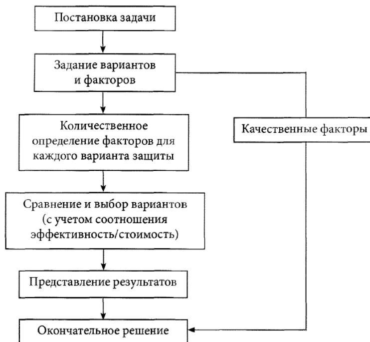
Рисунок 1 - Структурная схема процессов по оптимизации радиационной защиты
