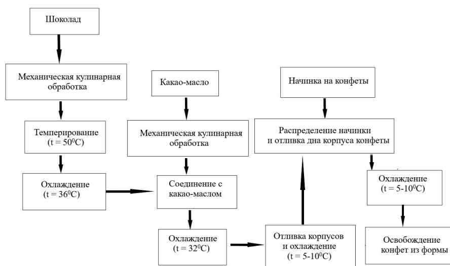
Рисунок 2 - Технологическая схема приготовления конфет класса «премиум» с фруктово-ягодной начинкой «Рябиновый сад» DOI: https://doi.org/10.60797/IRJ.2024.144.163.5
