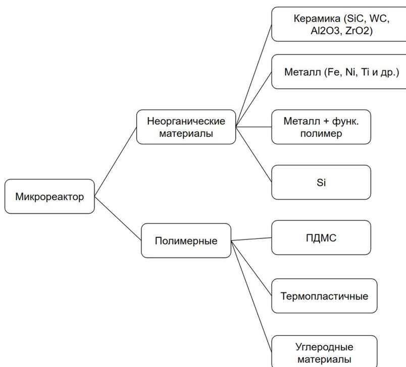
Рисунок 4 - Общая схема материалов для изготовления микрореакторов [12]
