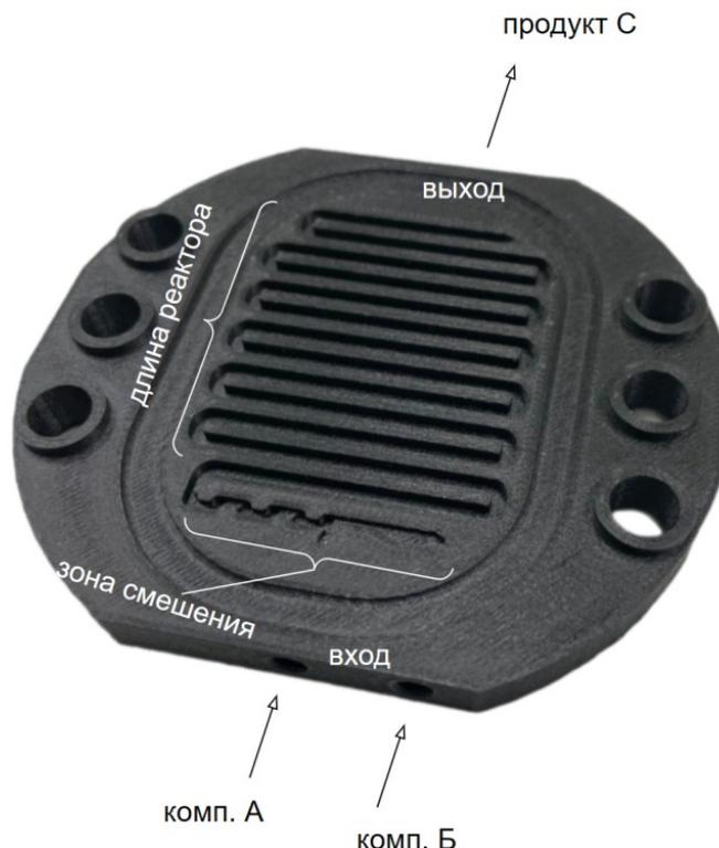
Рисунок 5 - Проектирование микрореактора: зона смешения, длина реактора [5]
