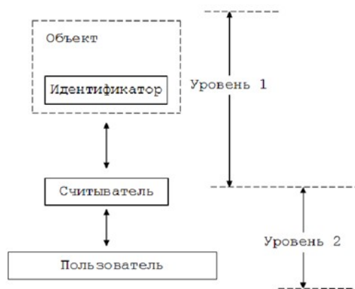
Рисунок 2 - Упрощенная структура системы радиочастотной идентификации DOI: https://doi.org/10.60797/IRJ.2024.144.32.2
