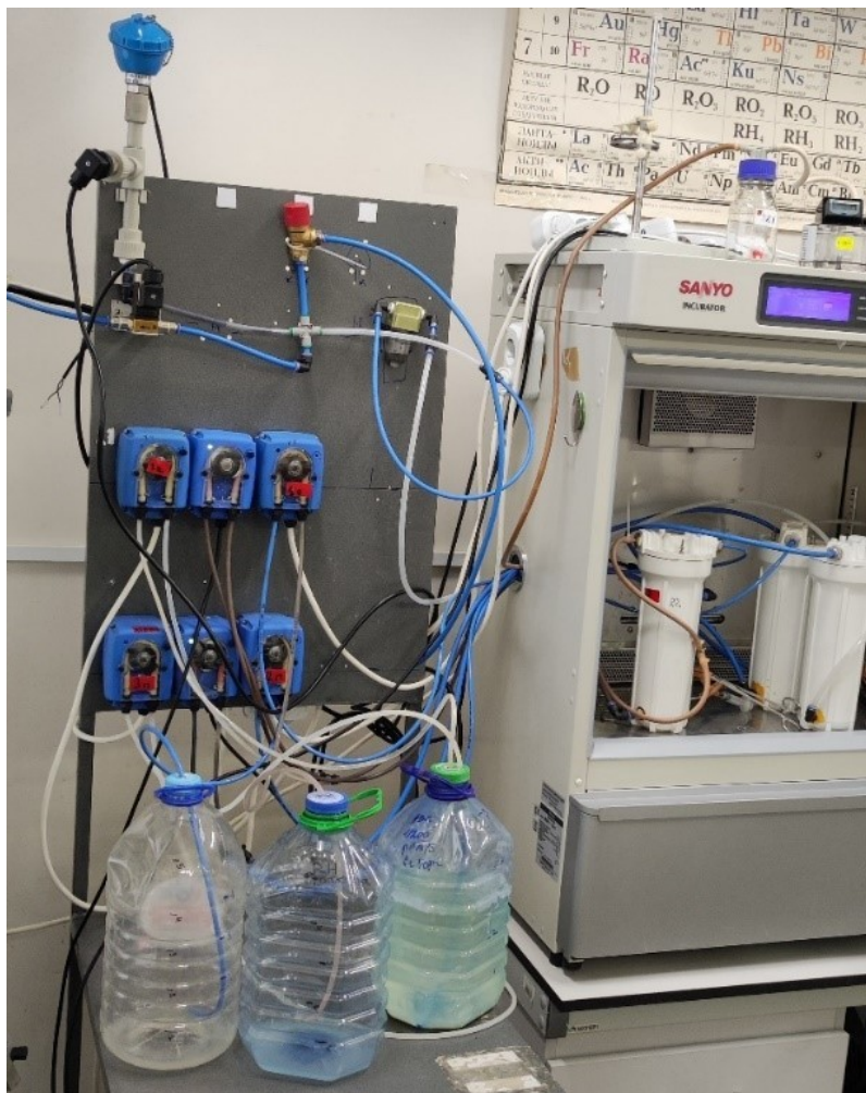
Рисунок 1 - Внешний вид установки для изучения непрерывного процесса анаэробной ферментации с реакторами, работающими при нормальном и избыточном автогенерируемом давлении в термофильном режиме
