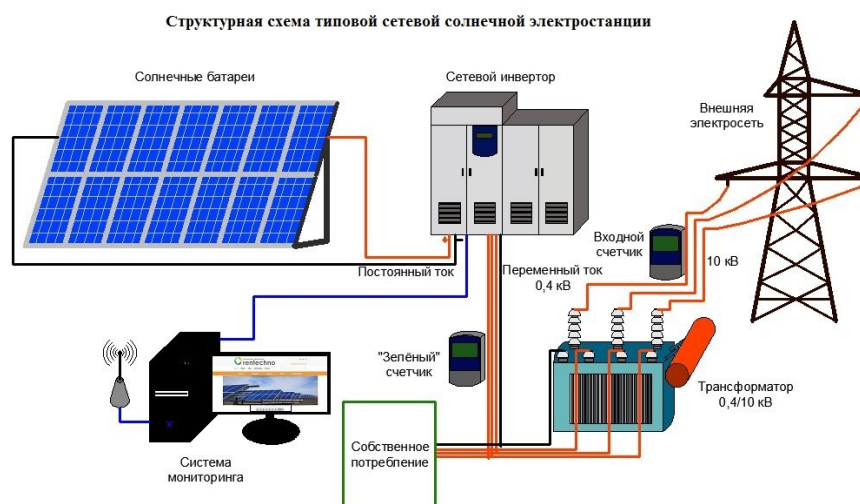
Рисунок 1 - Структурная схема подключения солнечной электростанции к потребителю
