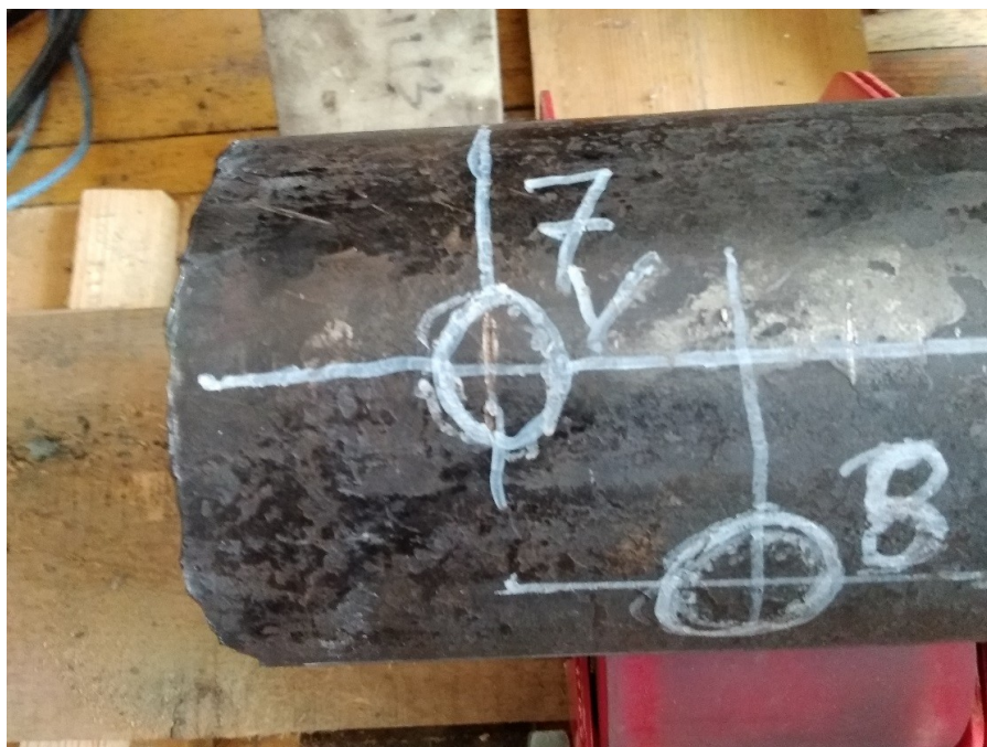
Рисунок 10 - Фотография дефектов № 7,8 тип: риска DOI: https://doi.org/10.60797/IRJ.2024.143.178.10
