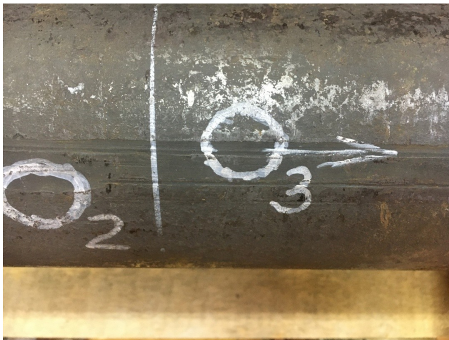
Рисунок 6 - Фотография дефектов № 2,3 тип: продольные подрезы DOI: https://doi.org/10.60797/IRJ.2024.143.178.6
