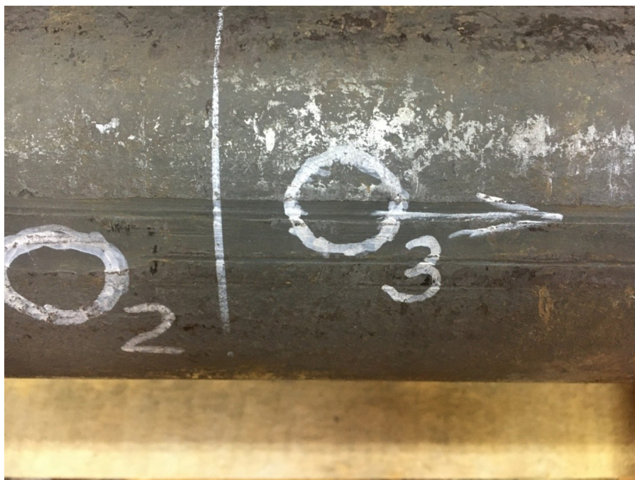
Рисунок 6 - Фотография дефектов № 2,3 тип: продольные подрезы DOI: https://doi.org/10.60797/IRJ.2024.143.178.6
