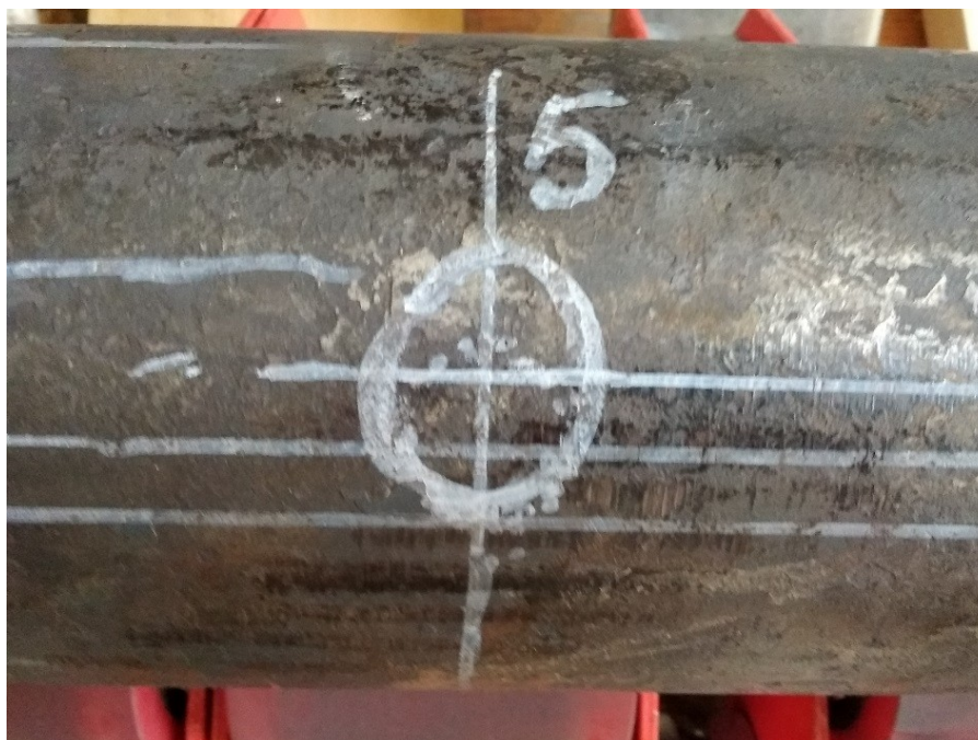
Рисунок 8 - Фотография дефекта № 5 тип: закат DOI: https://doi.org/10.60797/IRJ.2024.143.178.8
