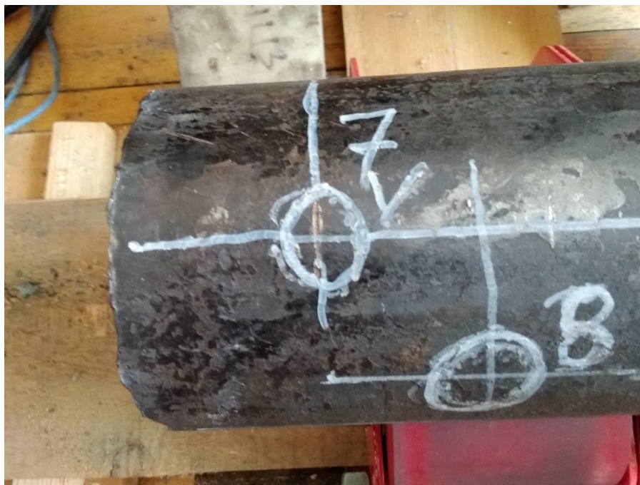
Рисунок 10 - Фотография дефектов № 7,8 тип: риска DOI: https://doi.org/10.60797/IRJ.2024.143.178.10
