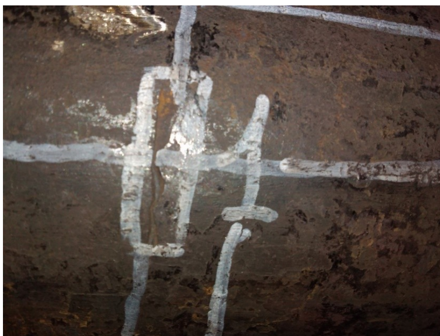
Рисунок 4 - Фотография дефекта тип: поперечная трещина
