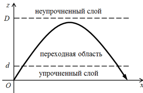
Рисунок 4 - Траектория акустического луча, развернувшегося в переходной области DOI: https://doi.org/10.60797/IRJ.2024.144.6.4
