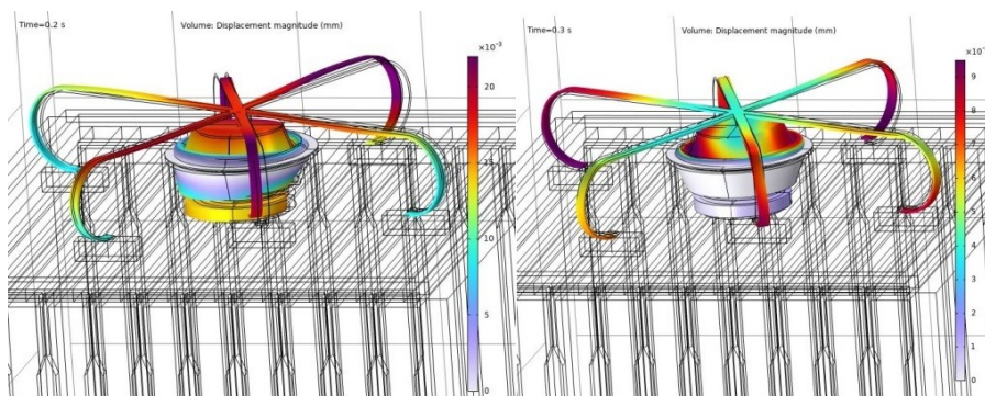
Рисунок 5 - Вид вибратора с перемещениями через 0,2 и 0,3 с DOI: https://doi.org/10.23670/IRJ.2024.142.31.5
