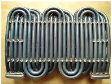
Рисунок 2 - Модуль теплообменника с 4 заходами во фланец
