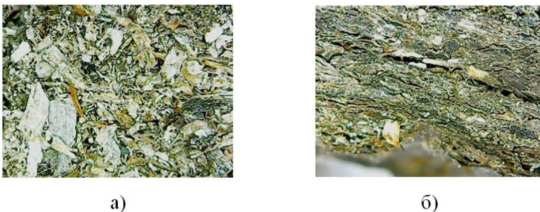
Рисунок 3 - Результаты микрофотографирования образцов на основе ПБС на основе водорослей после водопоглощения за 24 часа:
