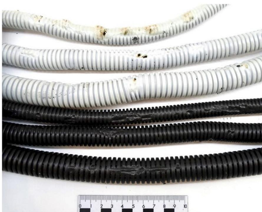
Рисунок 12 - Характерные повреждения гофрированных труб на экспериментальных образцах, после воздействия сверхтока силой от 266А (14 кр)
