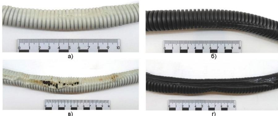
Рисунок 9 - Характерные повреждения гофрированных труб, выполненных из ПВХ (а, в) и ПНД (б, г) после воздействия сверхтока силой от 76 А (4 кр) (а, б) и от 114 А (6 кр) (в, г)
