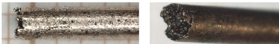
Рисунок 7 - Вид поверхности излома, характерный для токоведущих жил экспериментальных образцов в результате воздействия сверхтока силой от 228А (12 кР) и выше
