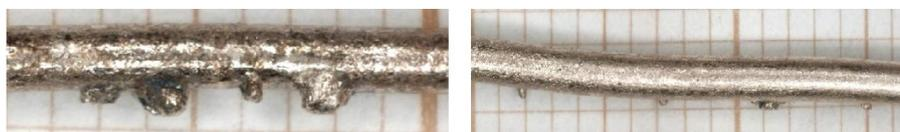
Рисунок 6 - Вдутья, образовавшиеся на поверхности медных проводников в результате протекания сверхтока силой 228 А и выше
