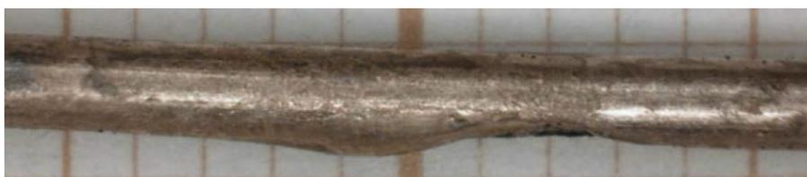
Рисунок 4 - Вид утолщения, характерного для медных проводников (экспериментальных образцов), после воздействия сверхтока силой от 152 А (8 кр) до 190 А (10 кр)
