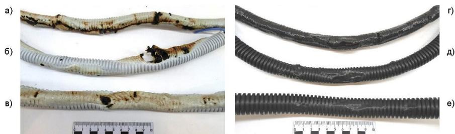
Рисунок 11 - Характерные повреждения гофрированных труб, после воздействия сверхтока силой 228 А (12 кр):
