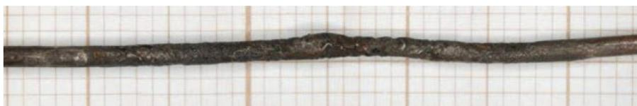
Рисунок 3 - Вид поверхностного оплавления, характерного для медных проводников (экспериментальных образцов), после воздействия сверхтока силой от 152 А (8 кр) до 190 А (10 кр)
