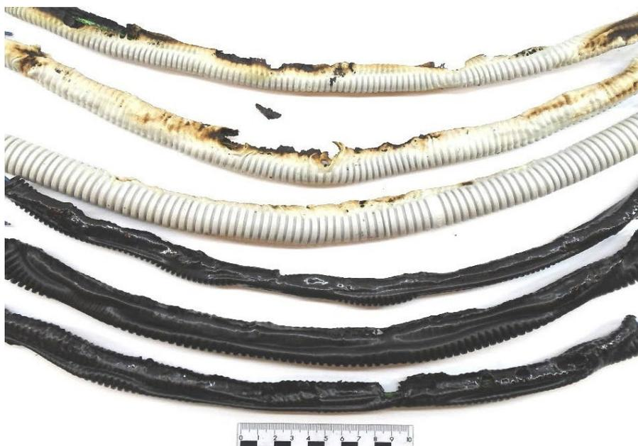
Рисунок 10 - Характерные повреждения гофрированных труб на экспериментальных образцах, после воздействия сверхтока 152А (8 кр) - 190 А (10 кр)
