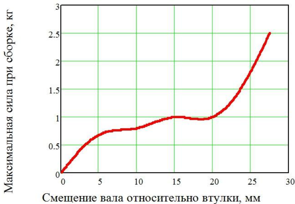
Рис. 5 – Зависимость максимального силового воздействия в момент сборки от величины первоначального отклонения
