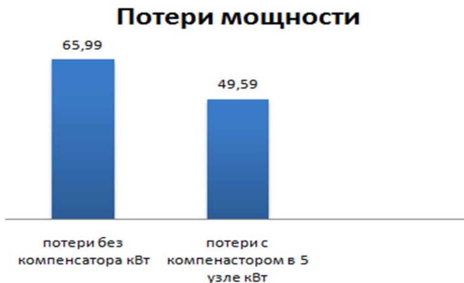
Рис. 7 – Потери мощности в сети без компенсатора и после компенсации
