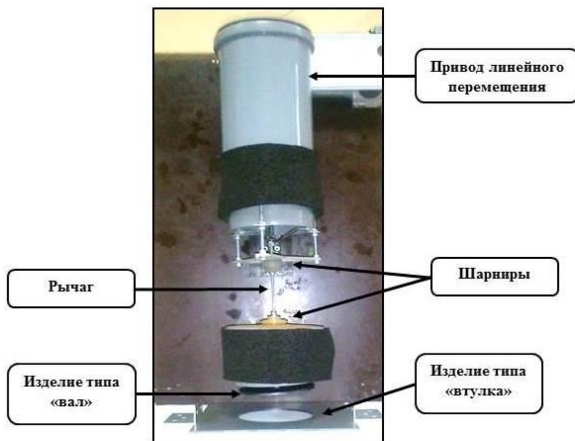
Рис. 3 – Макет однорычажного корректирующего модуля
