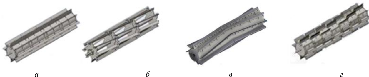
Рис. 2 – Форма барабана катка-измельчителя: а – с прямыми ножами; б – с винтовыми ножами; в – с клиновидными ножами; г – с шахматным расположением прямых ножей
