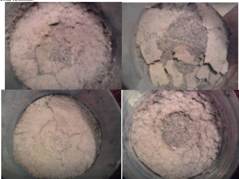
Рисунок 3-Образцы с толщиной поверхностного слоя 1 мм, 4мм, 5 мм и 10 мм (последовательно сверху вниз)
