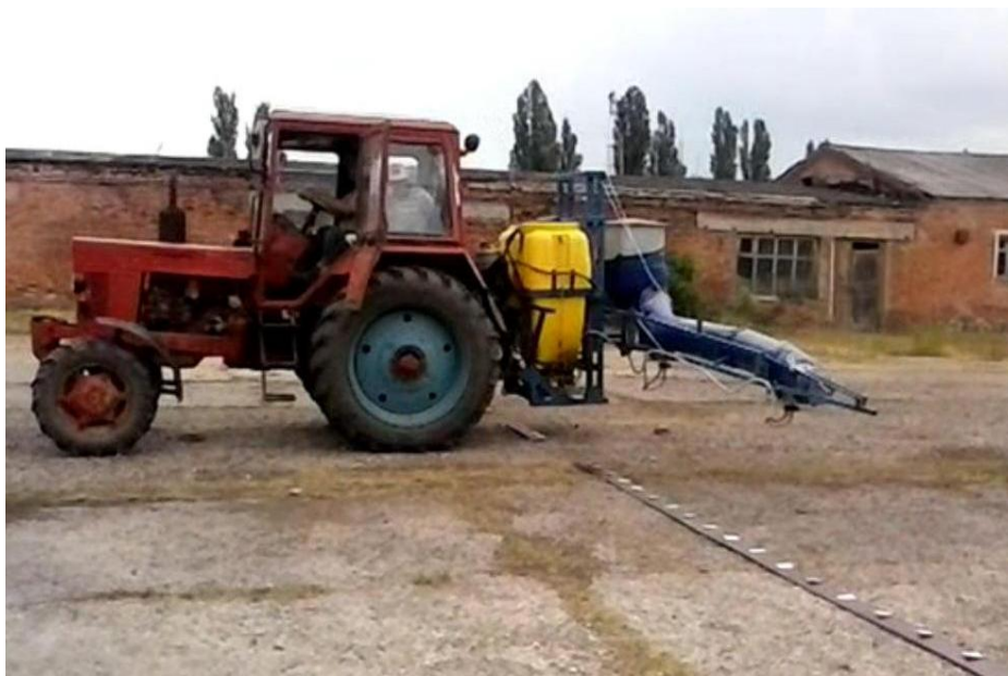
Рис. 2 – Общий вид опытного образца опрыскивателя, оснащенного пневмогидравлическими устройствами при прохождении лабораторных испытаний в составе МТЗ–82
